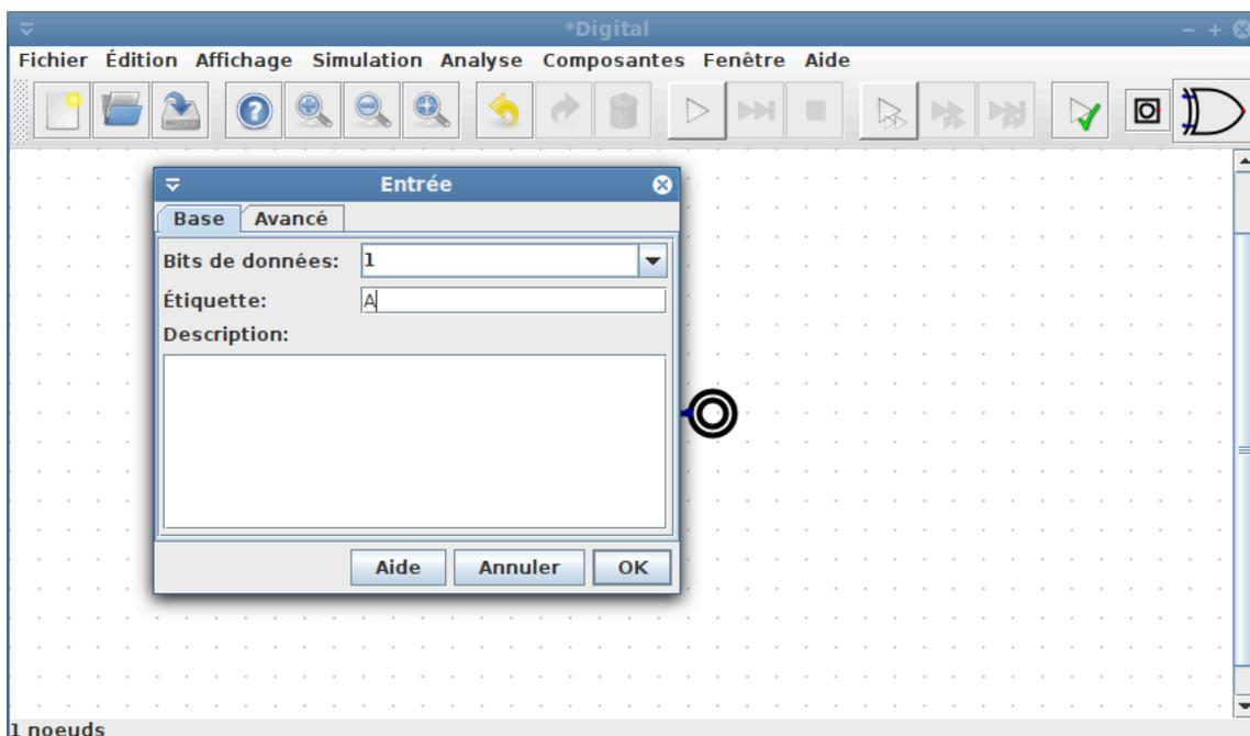
Pour améliorer le circuit davantage, la simulation doit d'abord être interrompue. La façon la plus facile de le faire est d'appuyer sur le bouton Arrêt dans la barre d'outils. En cliquant sur une composante avec le bouton droit de la souris (Ctrl+Clic sur macOS), un dialogue s'ouvre et affiche les propriétés de la composante. Une étiquette 'A' peut être définie pour cette première entrée avec le dialogue.
