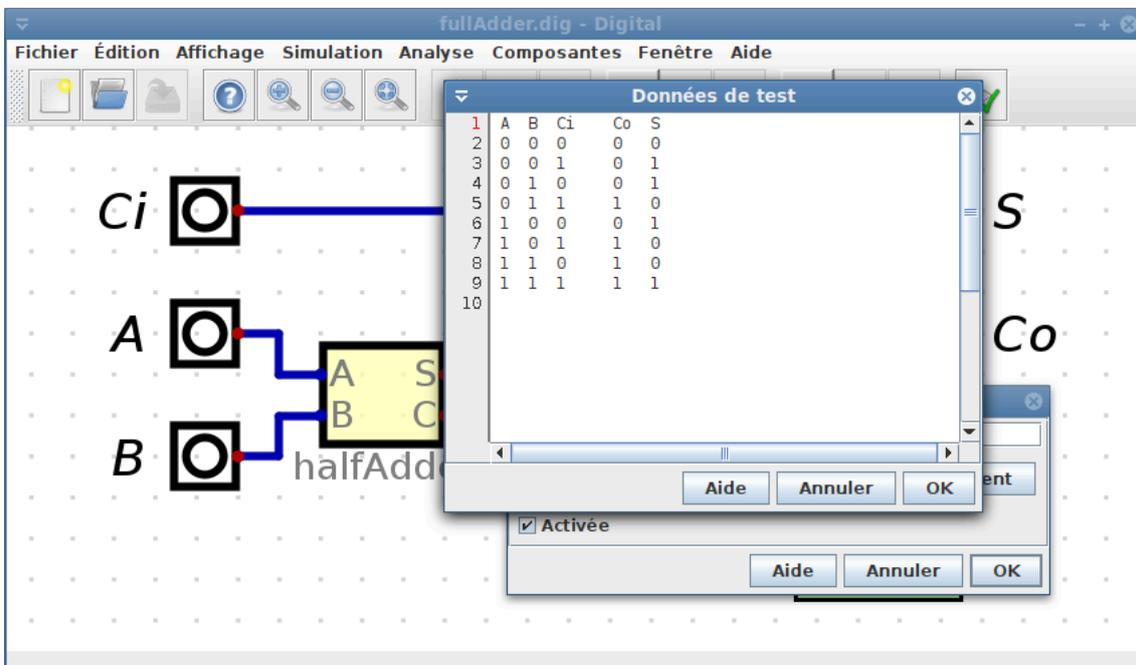
Pour vérifier le bon fonctionnement de l'additionneur complet, un test devrait être ajouté. Dans le test, une table de vérité est stockée et devrait correspondre à celle du circuit. Ainsi, il est possible de déterminer automatiquement si celui-ci fonctionne.
