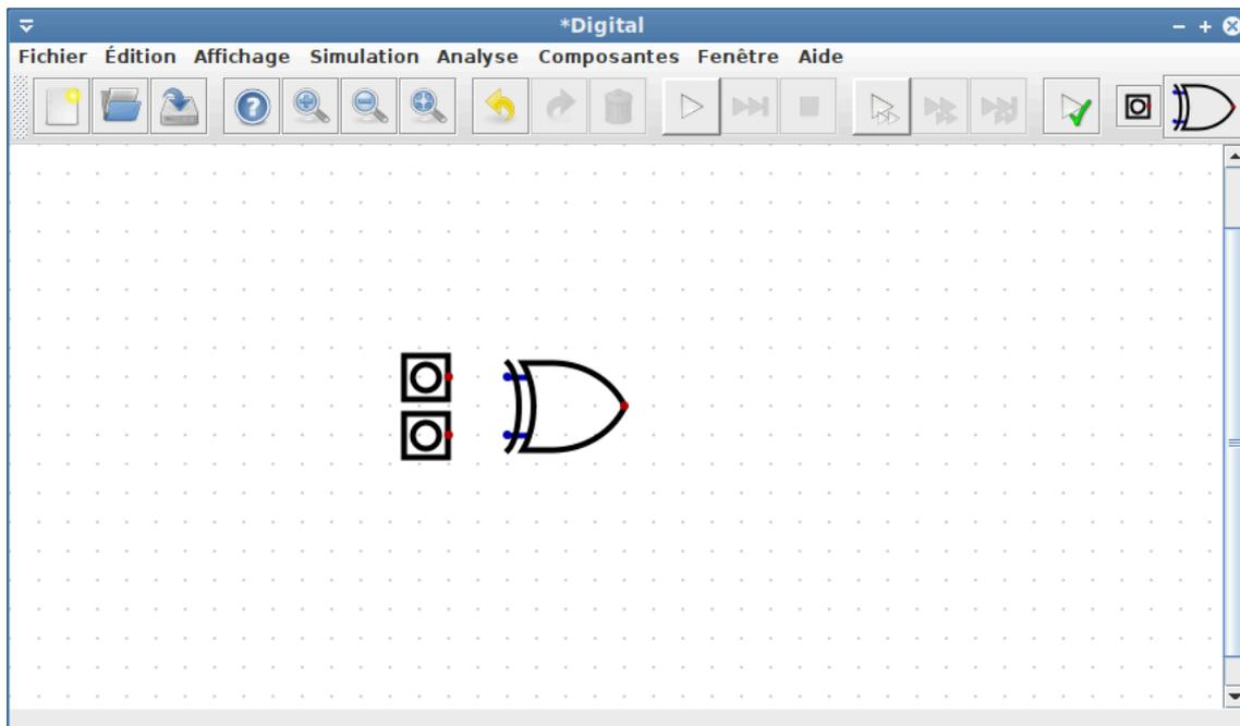
Cette porte peut ensuite être également ajoutée au circuit. Il vaut mieux la placer d'une manière à ce que le câblage subséquent soit le plus simple possible. Les points bleus indiquent les terminaux d'entrées de la porte.
