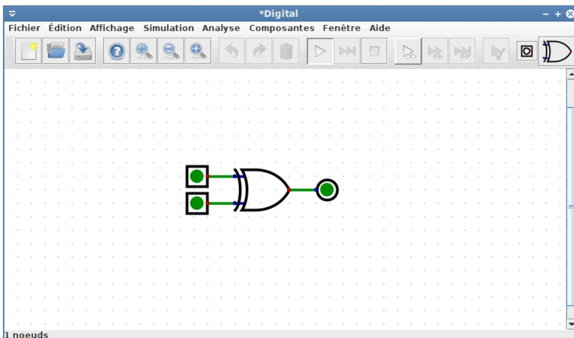
L'interaction avec le circuit est possible lorsque la simulation a commencé. Cela peut être fait avec le bouton Play situé dans la barre d'outils. Après avoir lancé la simulation, la couleur des fils, des entrées et des sorties change. Le vert pâle indique un '1' logique, tandis que le vert foncé indique un '0' logique. Dans la figure ci-dessus, tous les fils ont une valeur de '0'.
