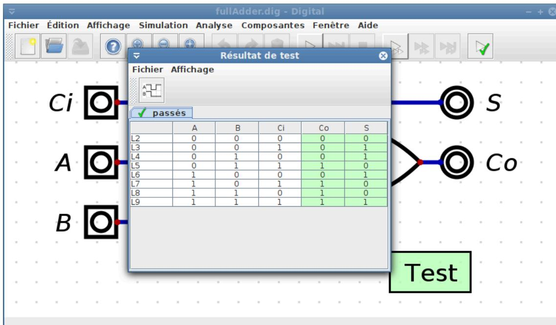
Les tests peuvent être exécutés à partir de l'éditeur de test ou avec le bouton de test dans la barre d'outils. Les cellules en vert dans la table de vérité indiquent que la sortie du circuit correspond à la table de vérité donnée pour ce test.
