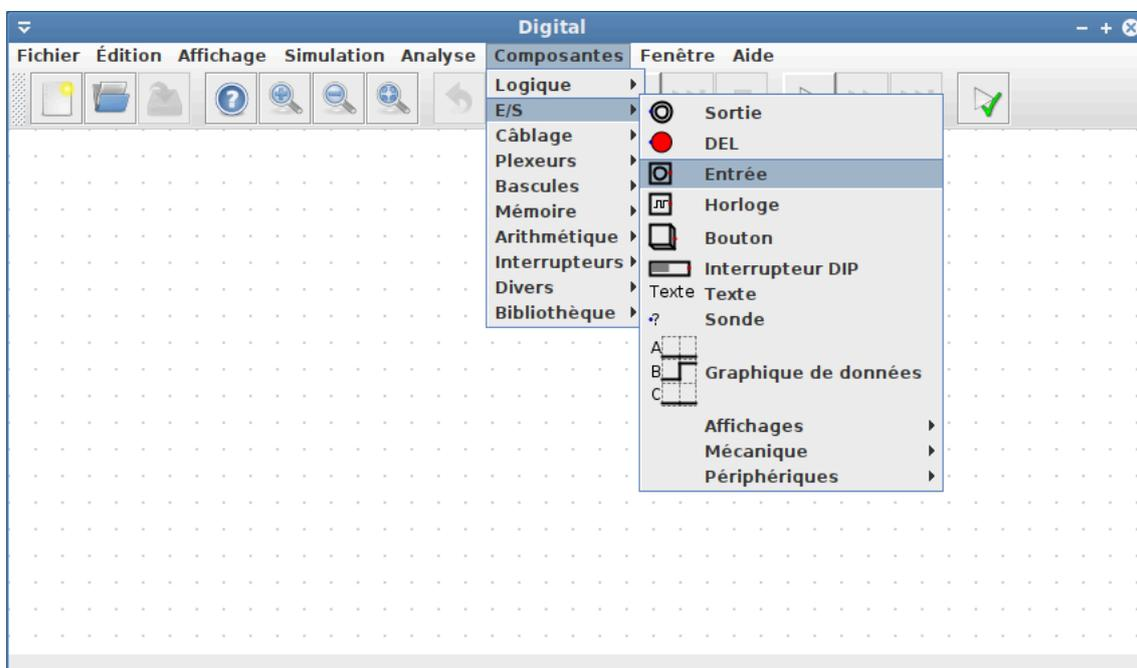
Comme premier exemple, un circuit sera construit avec une porte Ou-Exclusif, aussi appelée XOR. Depuis la fenêtre principale, un menu *Composantes* permet de sélectionner diverses composantes. Ensuite, elles peuvent être placées sur le volet de dessin. Ce processus peut être interrompu n'importe quand avec la touche Échap. Commencez par sélectionner une composante d'entrée. Celle-ci pourra plus tard servir à interagir avec le circuit avec la souris.
