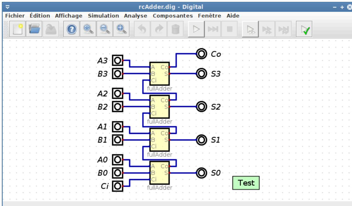
Maintenant, les additionneurs complets peuvent être assemblés pour former ce qu'on appelle un additionneur à propagation de retenue. Dans ce cas-ci, la sortie de retenue d'une addition est propagée comme retenue d'entrée de l'addition du bit suivant, comme c'est le cas pour une addition sur papier. Cet additionneur 4 bits devrait être testé pour vérifier son bon fonctionnement. Pour cette raison, un test a été inséré.
