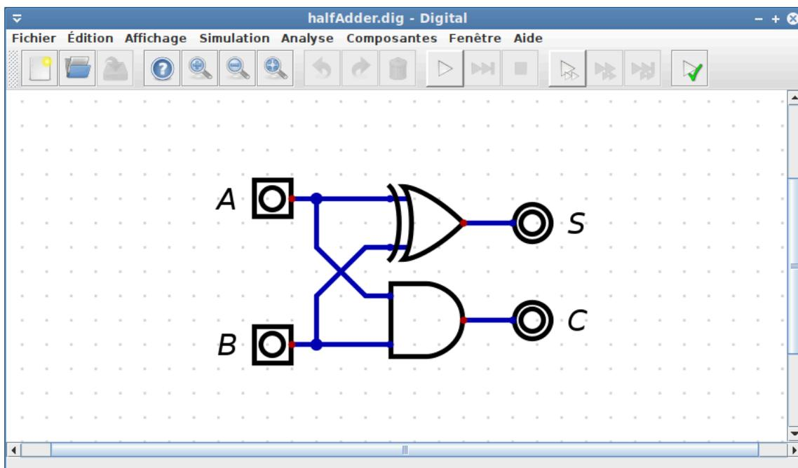
Comme exemple, considérez un additionneur 4 bits: d'abord, un demi-additionneur simple est construit. Celui-ci consiste en une porte XOR et une porte ET. La somme deux des bits 'A' et 'B' est donnée par les sorties 'S' et 'C'. Le circuit est stocké dans le fichier *halfAdder.dig*.
