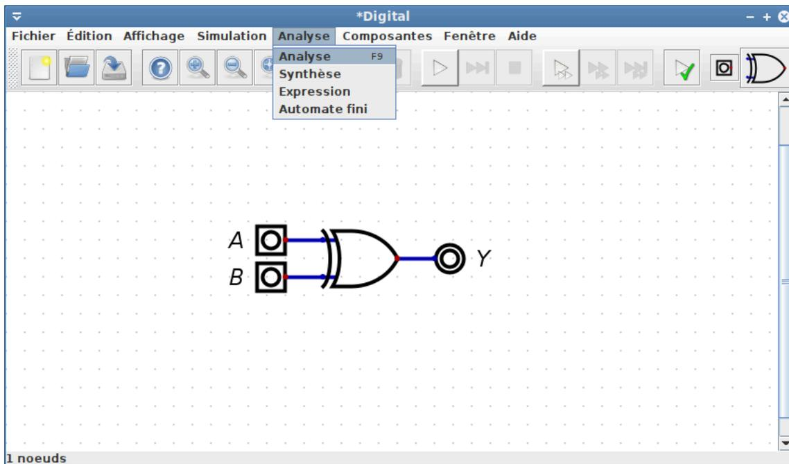
De la même façon, les étiquettes pour les autres entrées et la sortie peuvent être définies. Le menu *Analyse* contient un élément du même nom. Cette fonction effectue une analyse du circuit en cours. Cependant, il est seulement possible de la faire si toutes les entrées et sorties sont étiquetées correctement.
