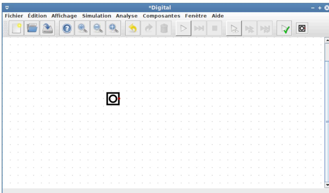
Après l'avoir sélectionnée, la première entrée peut être placée sur le volet de dessin. Le point rouge de la composante d'entrée sert à connecter la composante à un fil, qui sera ajouté plus tard. La couleur rouge indique une sortie. Cela veut dire que le port définit une valeur de signal et peut alimenter un fil.
